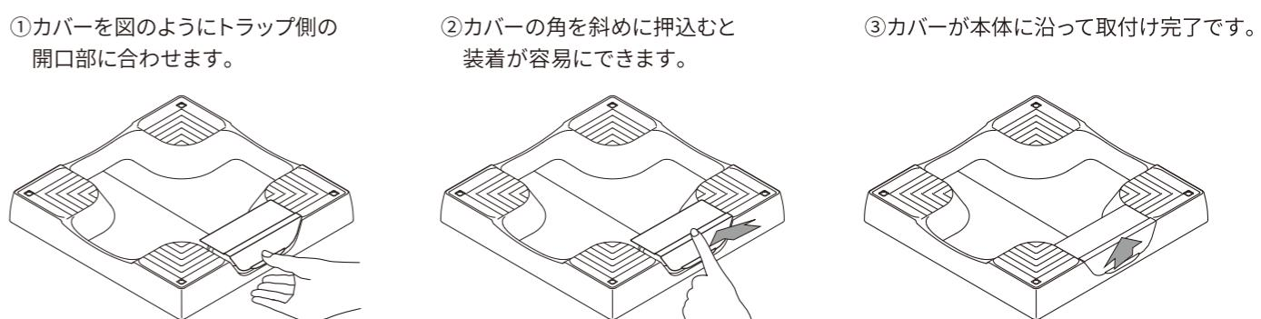
②カバーの角を斜めに押込むと装着が容易にできます。
